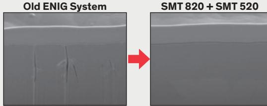
经过三次OSP后盲孔上方镍腐蚀大幅改善SEM图
