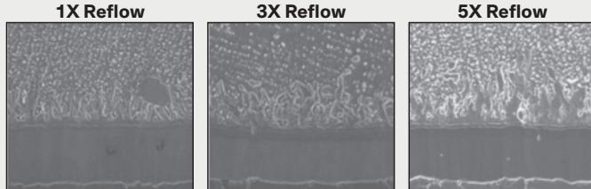
FIB切片明显可见三次OSP后没有镍腐蚀
