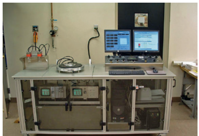
Abbildung 4. System zur Prüfung der mikrobiellen Barriere (ASTM F2638).
