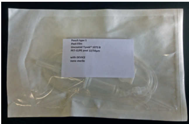
Abbildung 1. 2D Chevron-Beutelprobe mit Bluttransfusionsgerät
