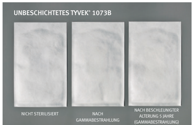
Abbildung 11. Medizinische Papiersorten wiesen nach der Gammastrahlensterilisation Vergilbungen auf. Bei keinem der Beutel mit Tyvek® 1073B oder Tyvek™ 2FS™ wurden Verfärbungen festgestellt.
