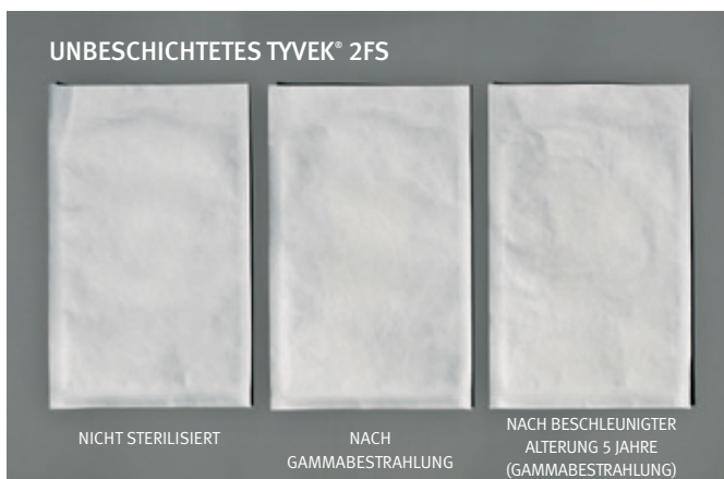
Abbildung 11. Medizinische Papiersorten wiesen nach der Gammastrahlensterilisation Vergilbungen auf. Bei keinem der Beutel mit Tyvek® 1073B oder Tyvek™ 2FS™ wurden Verfärbungen festgestellt.
