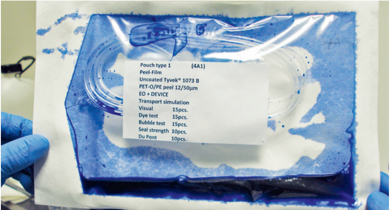
Abbildung 7. Farbeindringprüfung am Beutel
