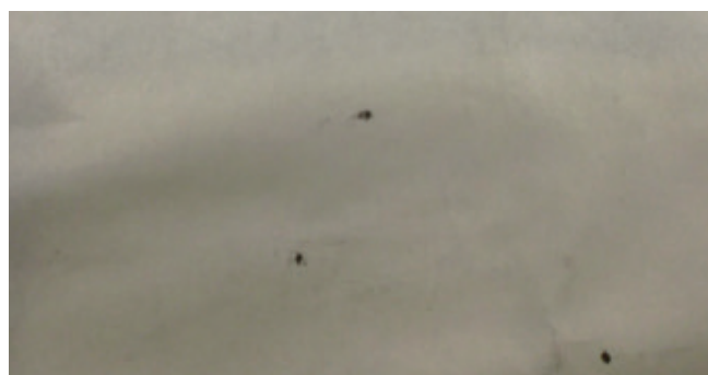
Figure 12. Photo microscopique (grossissement x175) de plis et perforation potentielle dans un sachet fait de papier 60 g/enduit « grid lacquer » 11 g. Le % pMax mesuré sur cet échantillon était de 12,22 %.
