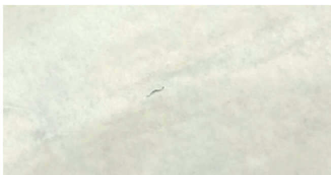
Figure 9. Présence confirmée de perforation sur ce sachet en papier 60 g/enduit « grid lacquer » 11 g.
