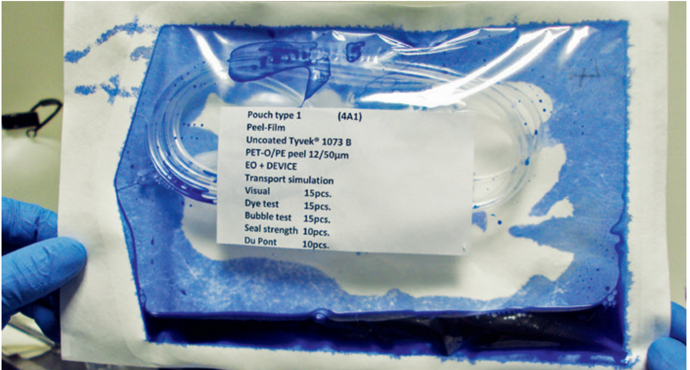
Figure 7. Test de pénétration d'encre sur les sachets.
