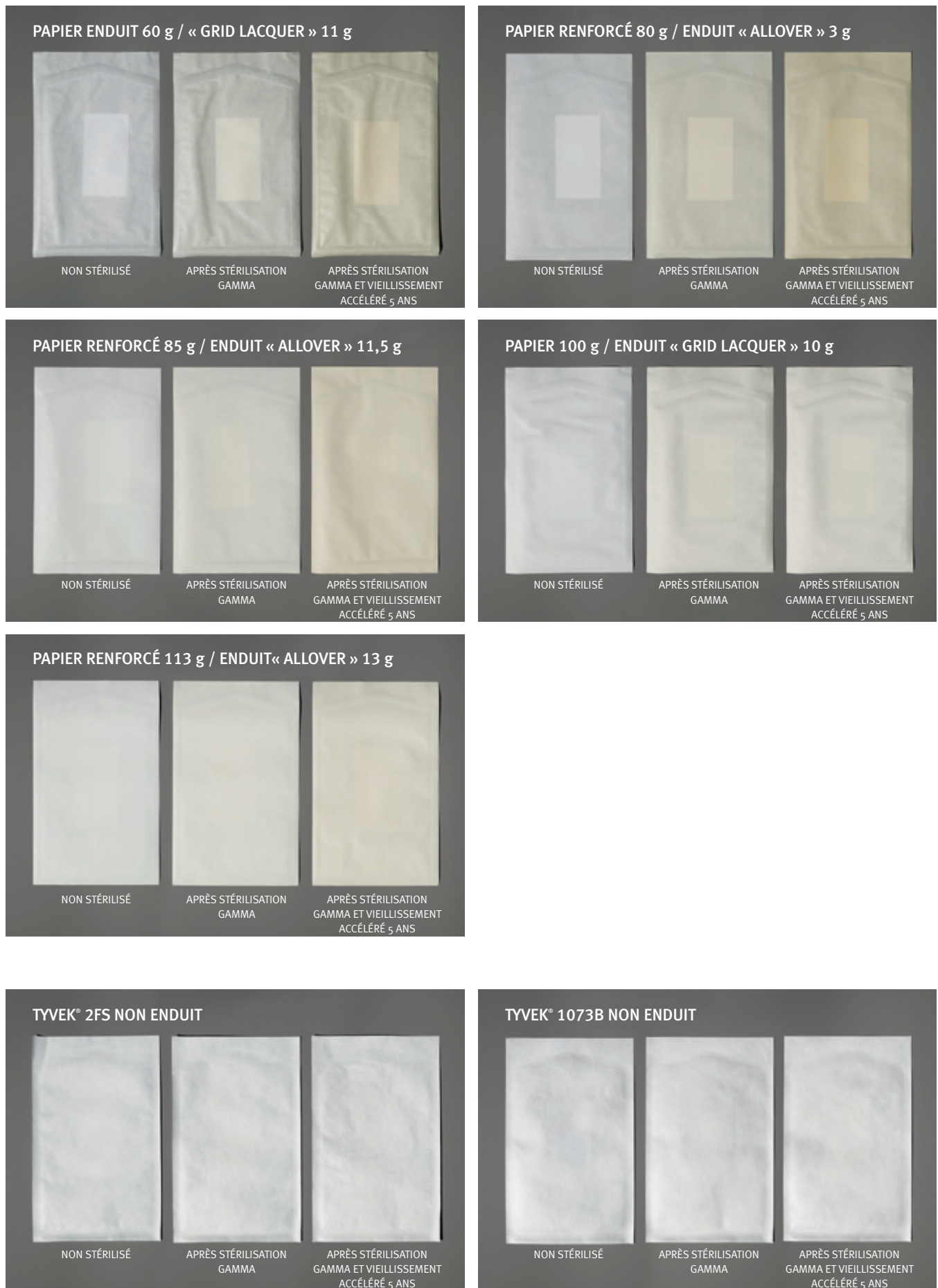
Figure 11. Les papiers de qualité médicale présentent un jaunissement après stérilisation aux rayons gamma. Aucun des sachets en Tyvek® 1073B ou Tyvek® 2FS™ ne présentait de décoloration.
