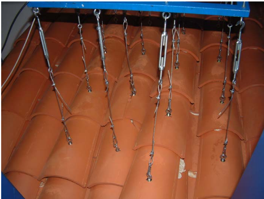
Fotografia 6: Dettaglio di fissaggio dei cavi alle tegole una volta provocato il distacco delle tegole
