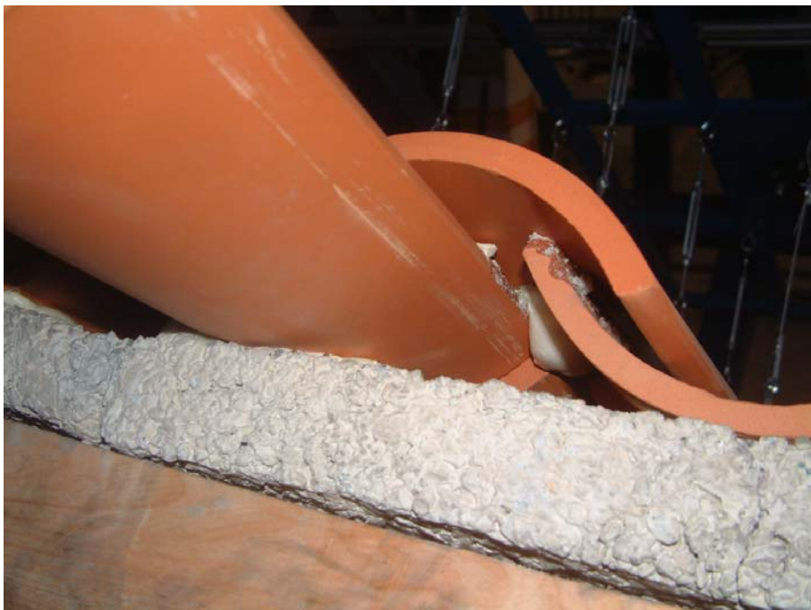
Fotografia 8: Dettaglio zona superiore del montaggio in cui si può vedere uno dei punti di applicazione del poliuretano
