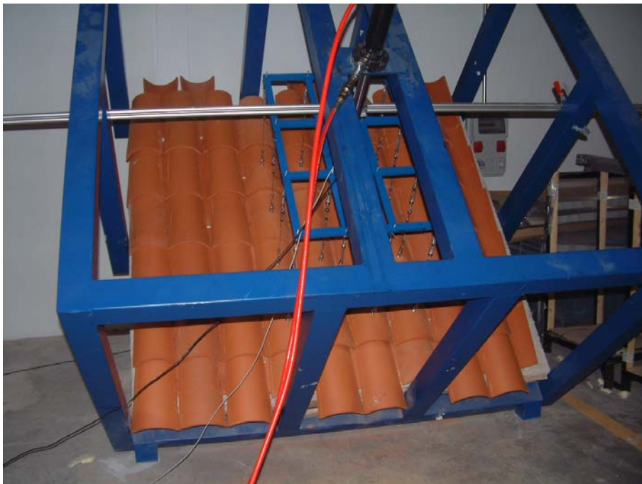
Fotografia 2: Veduta generale del banco di prova con il tetto e i cavi di trazione collocati
