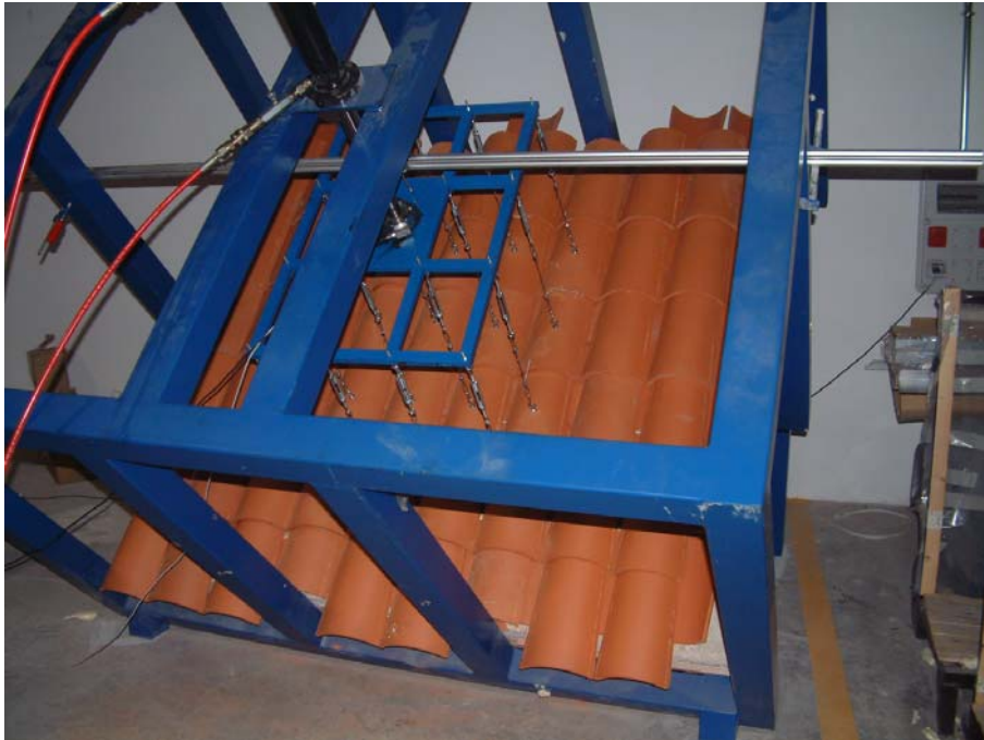
Fotografia 3: Veduta generale del banco di prova con il tetto e i cavi di trazione collocati
