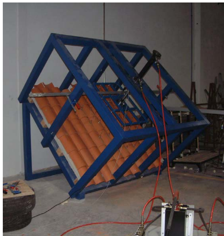
Fotografia 4: Veduta generale del banco di prova con il tetto e i cavi di trazione collocati durante il test
