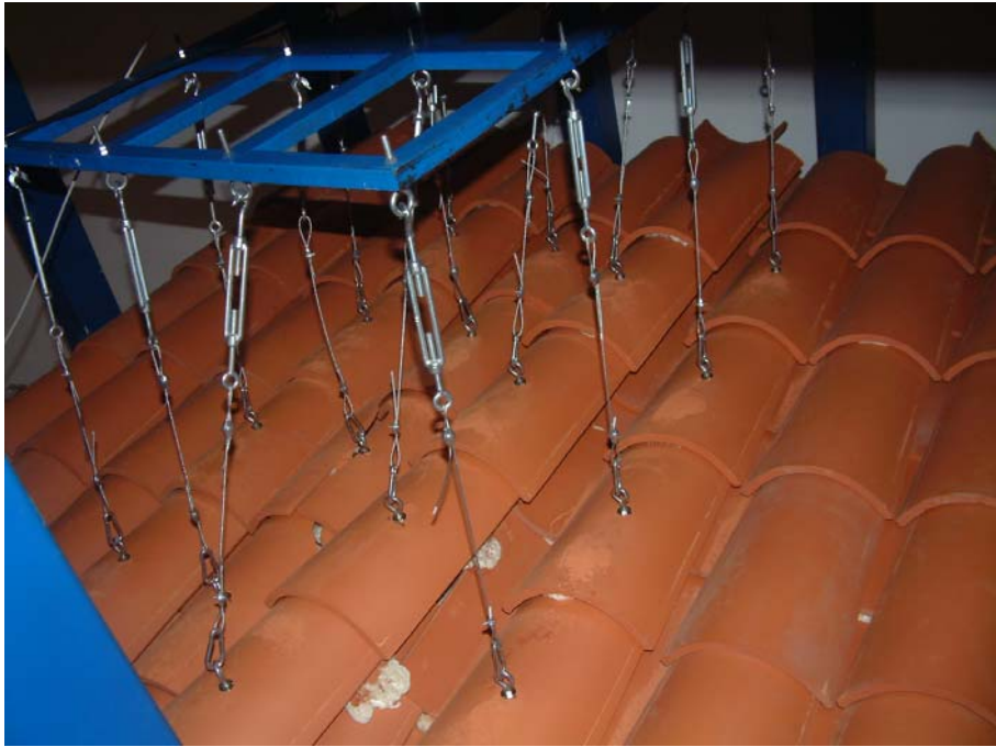
Fotografia 5: Dettaglio di fissaggio dei cavi alle tegole una volta provocato il distacco delle tegole
