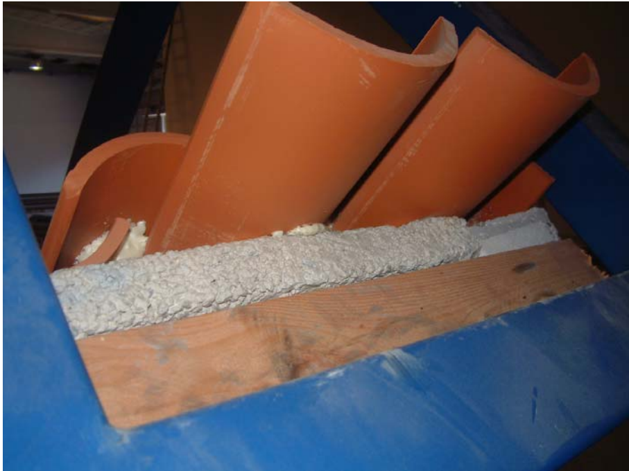
Fotografia 7: Dettaglio zona superiore del montaggio in cui si può vedere uno dei punti di applicazione del poliuretano
