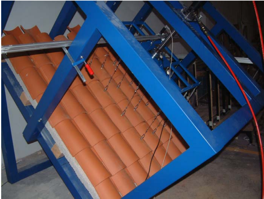
Fotografia 1: Veduta generale del banco di prova con il tetto e i cavi di trazione collocati
