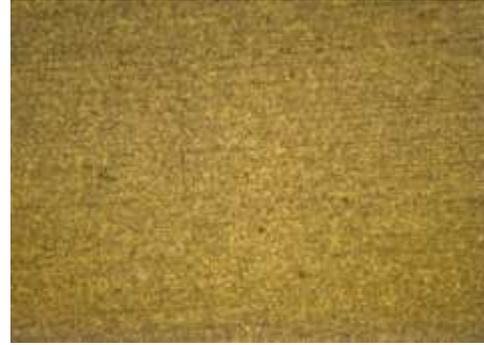
FIGURE 10. POROSITY TEST RESULT FOR NEW BATH
