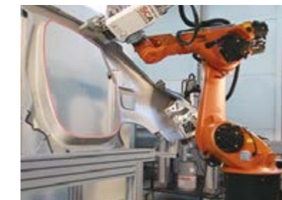
杜邦™ BETAMATE™结构粘合剂应用于车身结构粘合
