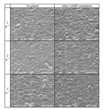
FIGURE 9. SEM INSPECTION OF THE NI/P SURFACE OF PAD OBTAINED FROM NEW BATH
