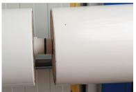
c) Hold the module and insert an  $\mathsf{DuPont}^\mathsf{TM}$  interconnector into the  $\mathsf{2^{nd}}$  module.
