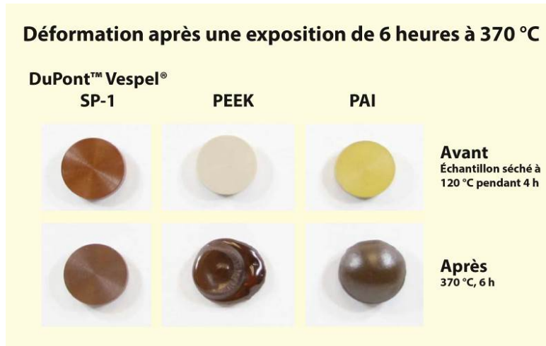
Fig. 5. L'illustration montre la déformation de résines PEEK et PAI pures sans charge après une exposition de 6 heures à 370 °C, alors que le Vespel® SP-1 sans charge reste intact. Le PEEK se ramollira à 140 °C alors que le Vespel® reste pratiquement intact à 350 °C+. De plus, les pièces Vespel® continuent à supporter des charges élevées à cette température, contrairement au PEEK. Source : DuPont
