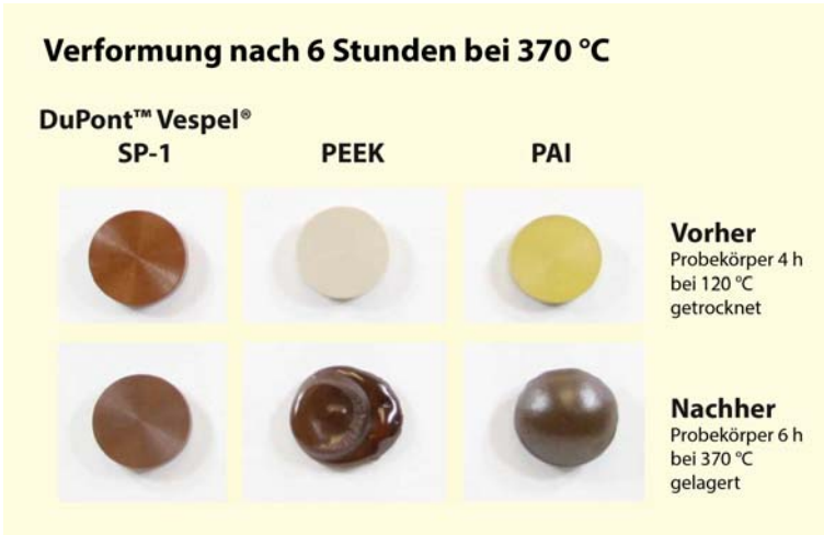
Bild 5: Verformung von ungefülltem PEEK und PAI nach 6-stündiger Lagerung bei 370 °C im Vergleich zu ungefülltem Vespel® SP-1, das keine Veränderung aufweist. PEEK erweicht bei 140 °C, während der Hochleistungskunststoff von DuPont bis 350 °C und darüber nahezu unverändert bleibt. Zudem können Vespel® Teile, anders als PEEK, auch unter diesen Temperaturen noch hohe Lasten aufnehmen.
